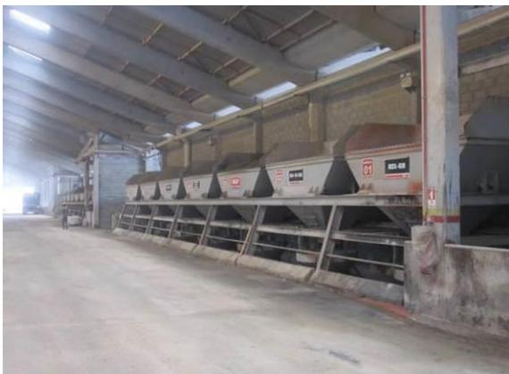
**Figura 3-2.** Vista detalhe das moegas automáticas das Misturas 3 e 4
