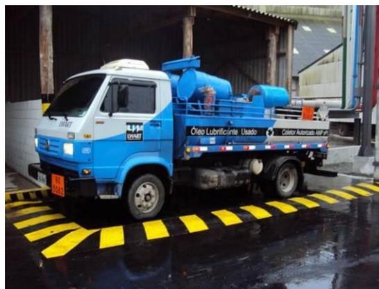
Figura 3-22. Visto local com dique de contenção destinado aos caminhões responsável pela coleta dos resíduos Classe I
