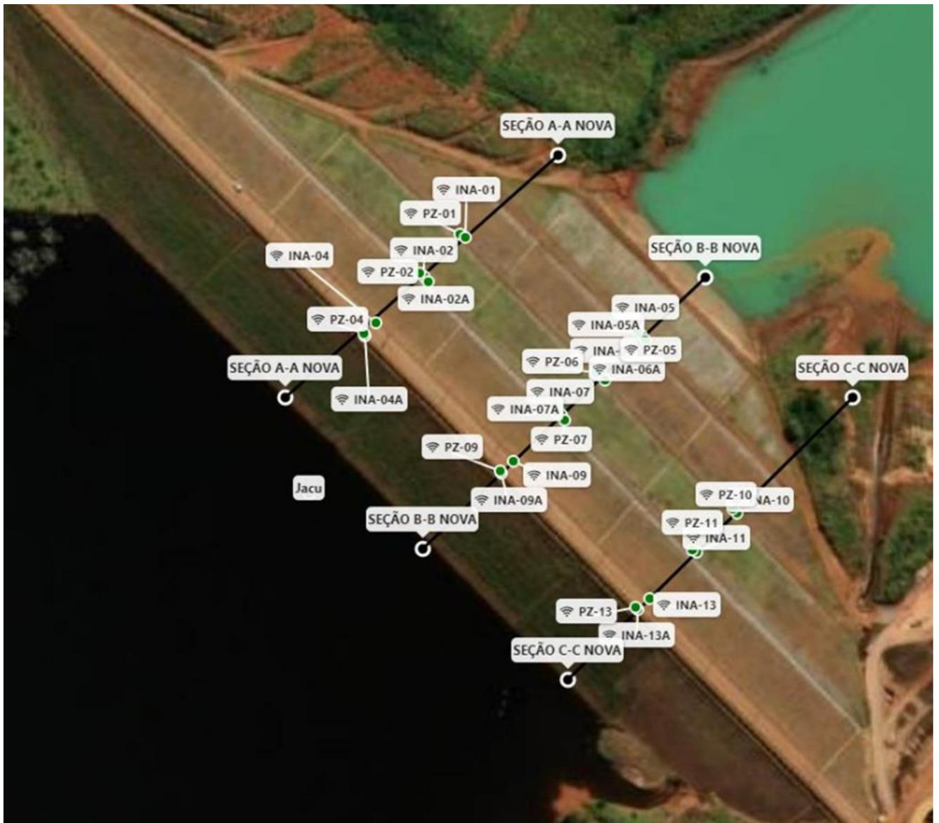
Figura 6.3 - Planta de localização do Sistema de Monitoramento da Barragem Jacu – El. 982m
