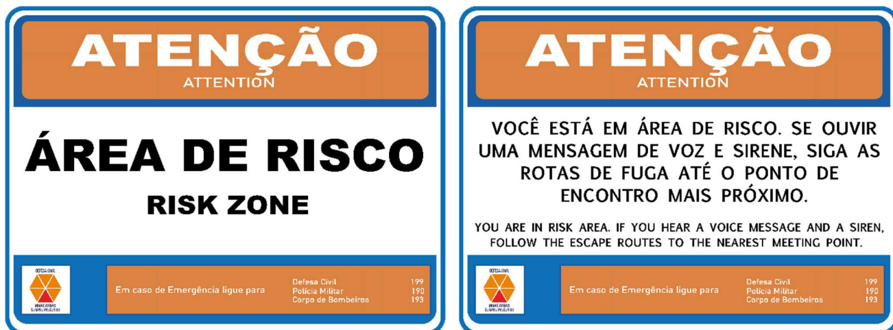
Figura 15.2 – Modelo das placas instaladas em área de risco – Advertência. Dimensão: 100cm x 75cm
